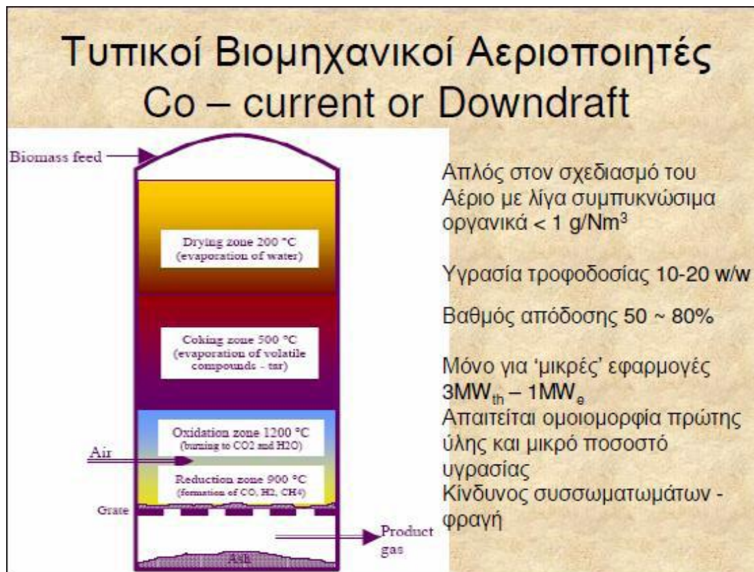
Εικόνα 3-6 : Τυπικοί Βιομηχανικοί Αεριοποιητές. Πηγή: Κούκιος Εμμανουήλ, Ανοικτά Ακαδημαϊκά Μαθήματα ΕΜΠ
