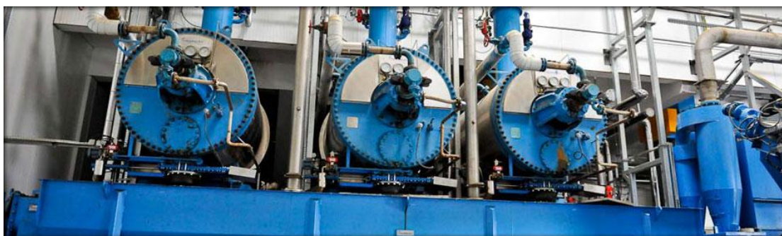
Εικόνα 4-2.Κλίβανοι θερμικής επεξεργασίας μονάδας μεταποίησης(cookers). Πηγή: http://utyilizacja.drobbogs.pl
